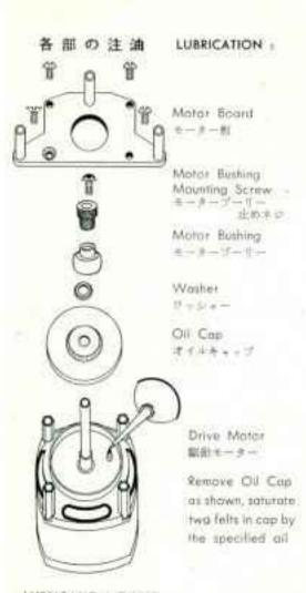
・アレコーダーBX常に使ってあるホーターは大型の自動輸出装置 を創建して切り、 投類期間転させても他切れになる心配はあり まけんだ、その負性能を主義させるためには 約400時間使用量 になに関酵してある如く一旦取り外して 情経再進曲することが 望ましいのです。 オイルキー・ブを外すとフェルト強いはスポー シの倫理のが見えませたら 或可く違い目の負責ミシン他を无 分に浸み込ませて下さい。(タービン他#1400と)は確認的です。)
