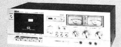
Platine magnétophone à cassette 709 D. Têtes GX. Compteur 3 chiffres à mémoire. Arrêt automatique. Pleurage maxi : 0,08 %. Bande passante : 30 - 17000 Hz. Signal-bruit avec Dolby : 60 dB au-dessus de 5 kHz.
